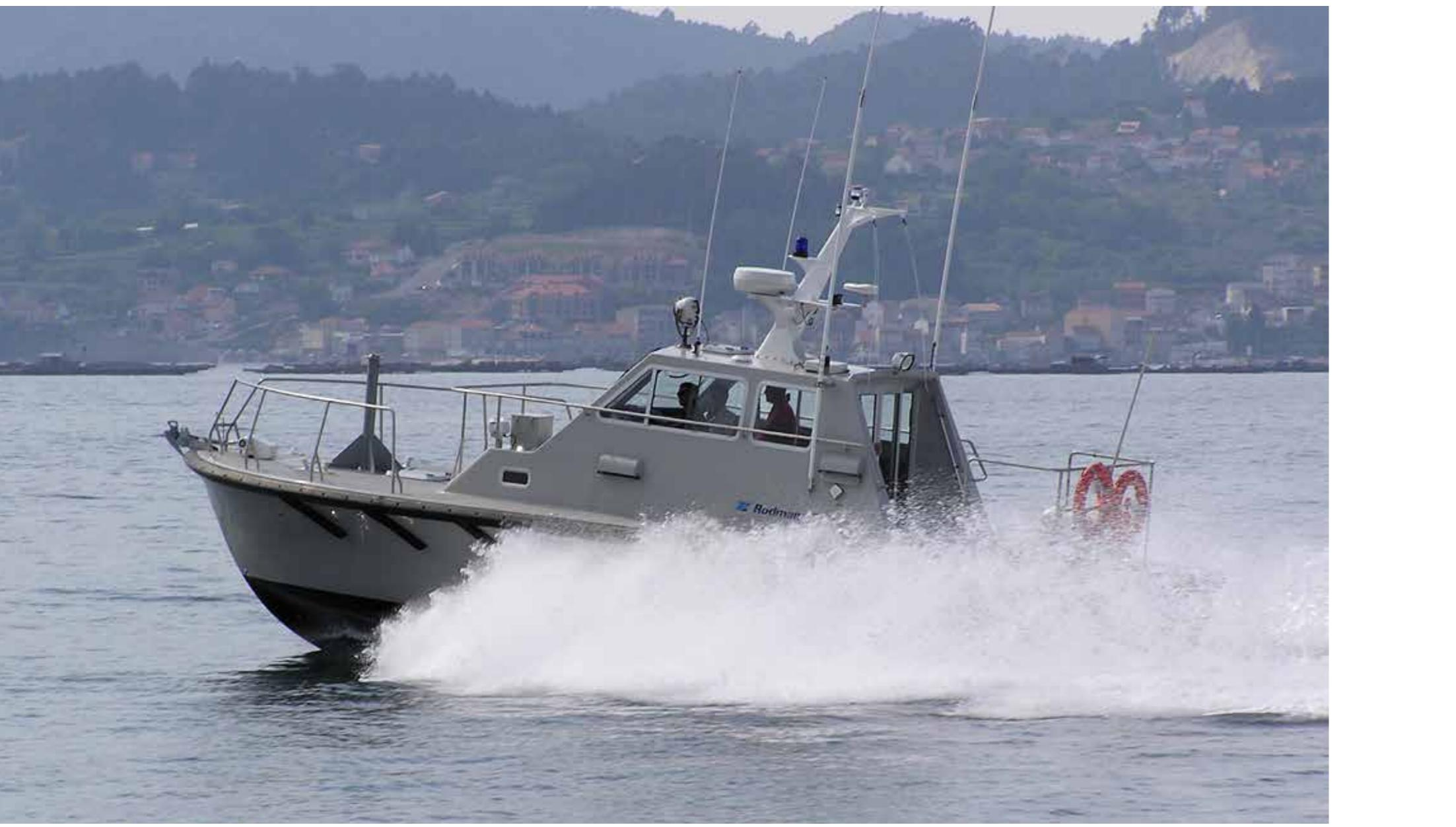
Con casi 12 m de eslora, esta patrullera alcanza unas velocidades de hasta 30 nudos, diseñada para la intervención y vigilancia de aguas costeras.
