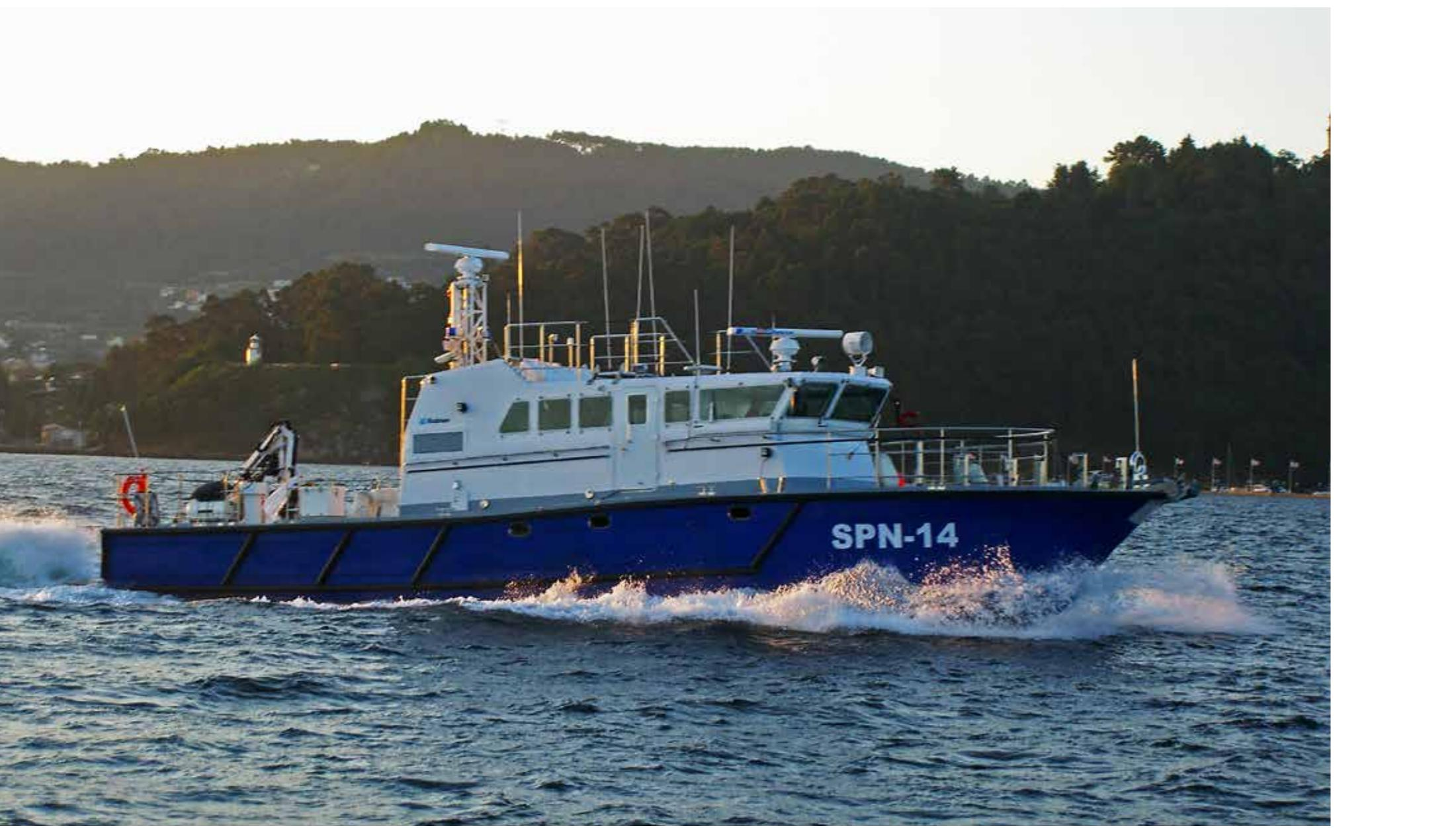
La versatilidad de su diseño y de sus motorizaciones le permiten adaptarse a diferentes usos como lancha de salvamento o patrullera de vigilancia costera, alcanzando velocidades máximas de 35 nudos en función de la motorización instalada.
